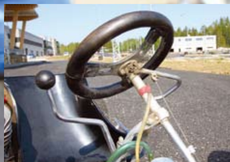
Roolist paremale jääb käigukang, kardil on kuus käiku, ning vasakule sidurihoob.
