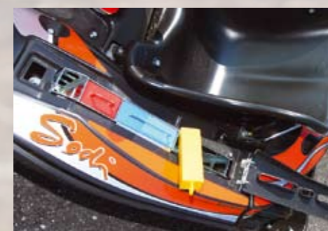
Sõitjate võrdustamiseks saab kardile lisada ballasti, 70 kg sõitjal pole 100 kg-se ees eelist.
