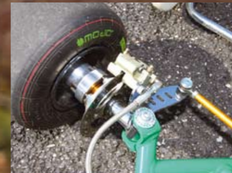
Mõistagi kasutatakse uuel kardil hüdraulilisi ketaspidureid, mis on ka ventileeritavad.
