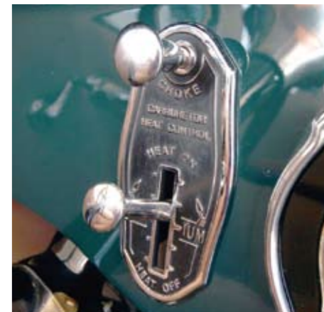
Ülal nn toore klapp, alumiselt kangilt saab reguleerida karburaatori õhuvõttu (soe või külm).
