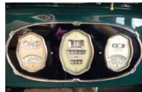
Näidikuploki keskel on spido-, vasakul amper- ja mano-, paremal termomeeter ja kütusenäidik.
