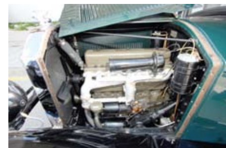
Buicki mootor arendab 64 hobujõudu. Mootori hääl sarnaneb natuke GAZ-51 kõlaga.
